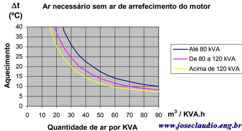
O diagrama acima, mostrando as quantidades de ar exigidas para a dissipação do calor irradiado pelo motor, o calor devido às perdas do alternador e incluindo o ar de combustão necessário às diversas diferenças de temperatura admissíveis por kVA, satisfaz plenamente, para uma elaboração de projeto.
