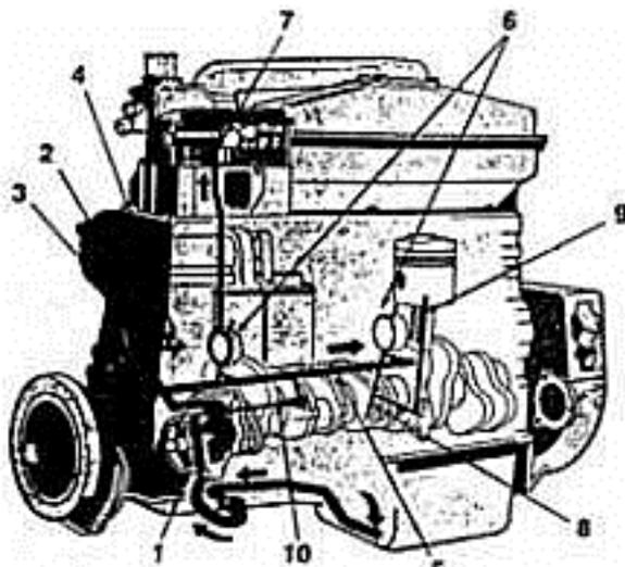
**Sistema de Lubrificação do motor Cummins Série N/NT/NTA-855.**
