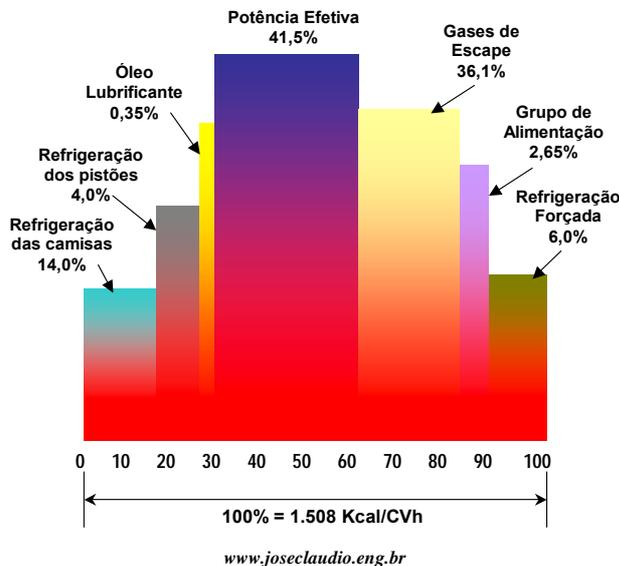
Diagrama de fluxo térmico de um motor Diesel de grande cilindrada com turbocompressor acionado pelos gases de escape e refrigeração forçada.
