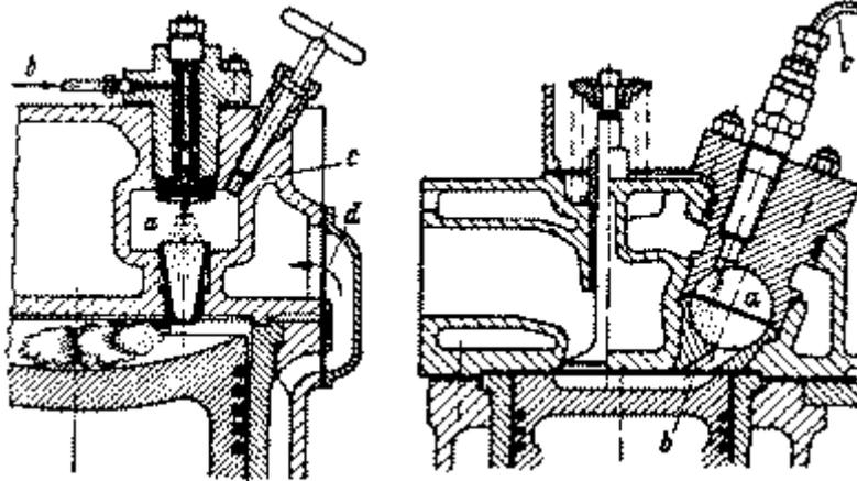
**Antecâmara no cabeçote de um motor Diesel de 4 tempos.**
