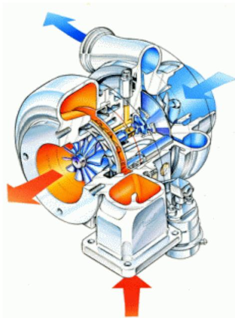
Constituído por um conjunto de dois rotores montados nas extremidades do mesmo eixo, o turbocompressor é acionado pela energia cinética dos gases de escape que impulsiona o rotor quente (ou turbina) fazendo com que o rotor frio (compressor radial) na outra extremidade impulsione o ar para os cilindros.
